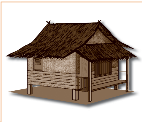
Gambar 7.11 Atap jerami kurang kuat, mudah lapuk dan sering bocor. Namun, jika tetap dipakai bagian bawahnya harus dilapisi bahan anti bocor.
